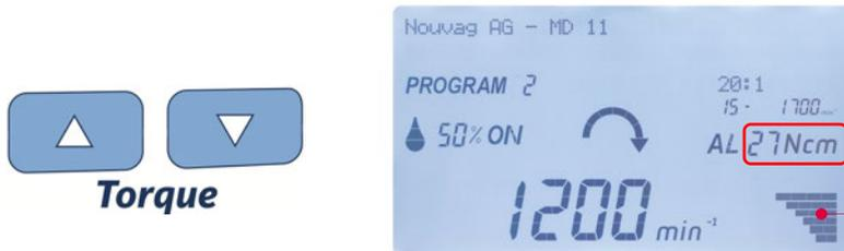
Aquí se representa gráficamente la evolución del par de giro. Al alcanzar el par de giro configurado están visibles todos los elementos de la barra.
