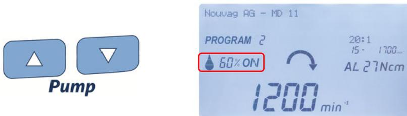
En el menú de configuración se puede adaptar el mínimo y el máximo del caudal, además de los incrementos (ver «7.8 Menú de configuración, Parámetro Nivel 2, Pump»).
