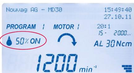
El caudal mínimo y máximo de la bomba, así como los pasos de mando se pueden ajustar en el menú de configuración (ver «7.8 Menú de configuración, Parámetro Nivel 2, Pump»).
