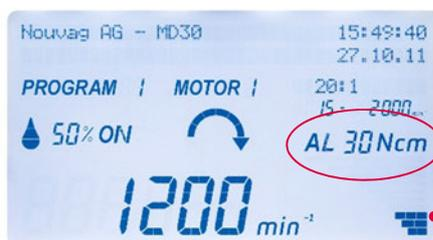
Aquí se representa gráficamente la evolución del par de giro. Al alcanzar el par de giro configurado están visibles todos los elementos de la barra.
