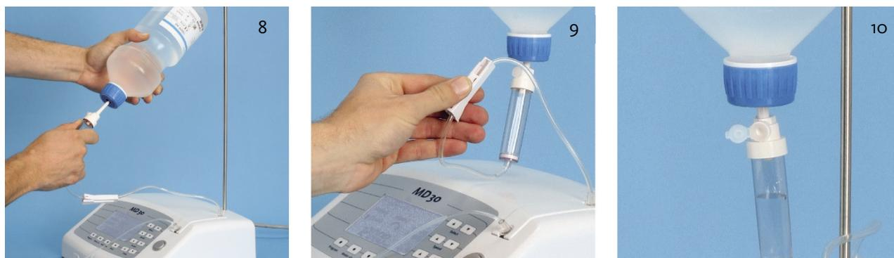
8. Insertar el mandril situado en el extremo del set de tubos en la membrana de goma del tapón de la botella de medio refrigerante y colgar la botella en el soporte.
