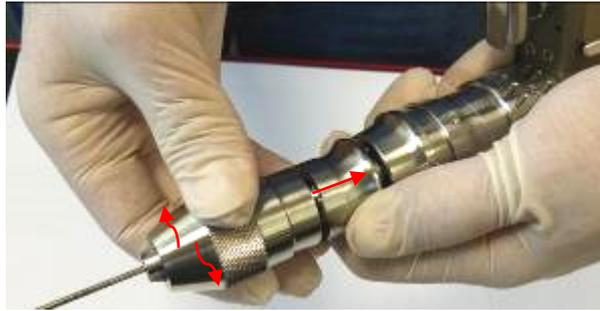
Pour ouvrir les modèles 3722 et 3723, maintenir la bague postérieure du mandrin et tourner la bague antérieure dans le sens des aiguilles d'une montre.
