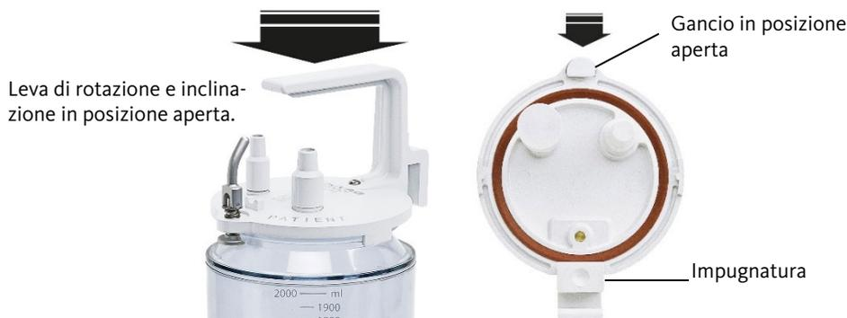
3. Ruotare di 180° la leva di rotazione e inclinazione (la leva di rotazione e inclinazione ora è distante dall'impugnatura). Accertarsi che l'impugnatura prenda tutto il bordo del contenitore.
