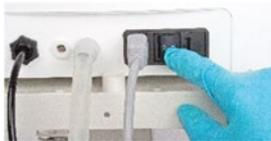
Utilizzare l'interruttore "I/O", sul retro del dispositivo, per accendere e spegnere il dispositivo. Lo standby viene segnalato dalla luce di stato a LED sulla parte anteriore del dispositivo. Il dispositivo può essere spento in qualsiasi momento, a prescindere dal tipo di procedura di spegnimento utilizzata.
