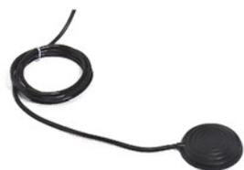
Il pedale di accensione e spegnimento pneumatico standard in dotazione, quando premuto, attiva un interruttore nella pompa Vacuson che accende e spegne la pompa. Questo si mantiene tramite un cuscino d'aria. Una volta acceso il dispositivo, il pedale pneumatico deve essere premuto per attivare la pompa e generare il vuoto. Premendo nuovamente, la pompa viene disattivata. La pompa può essere unicamente attivata tramite il pedale. L'ultimo stato di utilizzo prima dello spegnimento resterà attivo.
