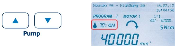
La portata minima e massima della pompa nonché i passi di comando possono essere adattati nel menu di configurazione [PARAMETRI | LIVELLO 2 >19], «Pump».
