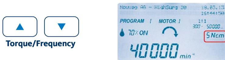
Quando a peça de mão shaver for usada no modo de oscilação, o número de oscilações por segundo da lâmina do shaver (número de mudanças de direção da rotação da lâmina por segundo) é ajustada com essas duas teclas. Nesta função, a seta indica ambas as direções.
