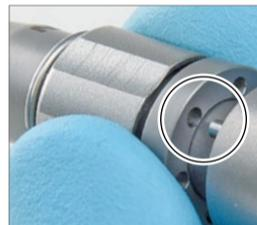
Al colocar el duraprotector en el craneótomo, asegúrese de que los dos pasadores de la pieza de mano estén alineados con las aberturas del anillo de bloqueo.
