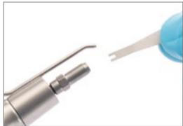
Rimuovere la lama della sega dalla pinza e sostituirla se necessario.
