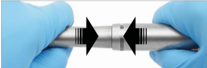
Mover la pieza de mano encima de la soporte de la pieza de mano hasta que se detenga. Presione hasta que encaje. Comprobar el ajuste con un movimiento contrario.
