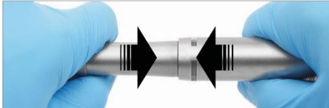
Faites glisser la pièce à main sur le support de la pièce à main jusqu'à la butée. Appuyer jusqu'à ce qu'il s'engage. Vérifiez s'il y a de bonnes places assises avec un contre-mouvement.
